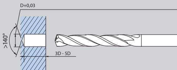
При обработке глубоких отверстий с входом в криволинейную поверхность используйте сверло с плоским торцом серии ADF для подготовки плоской площадки под пилотное сверло.
