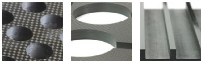
Композиционные материалы (CFRP)
