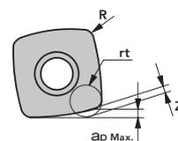
Программирование осуществлять с учетом симуляционного R Unit: мм
