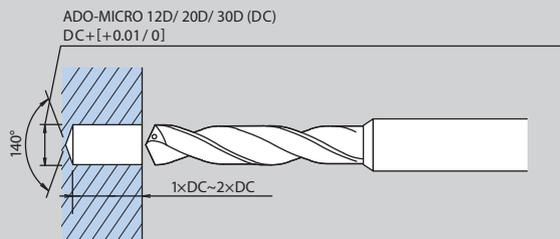
При обработке глубоких отверстий с входом в криволинейную поверхность используйте фрезу FX-ZDS или сверло с плоским торцом серии ADF для подготовки плоской площадки под пилотное сверло.
