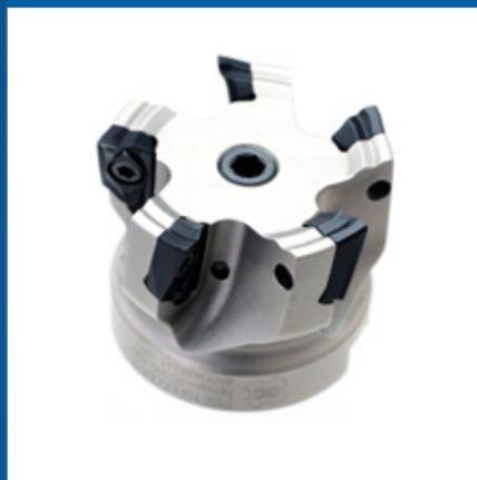
Инструменты со сменными пластинами используются для предварительной обработки деталей. Эти инструменты предназначены для черновой и получистовой обработки при формировании предварительного контура детали. В качестве режущей части используются сменные многогранные неперетачиваемые пластины.
