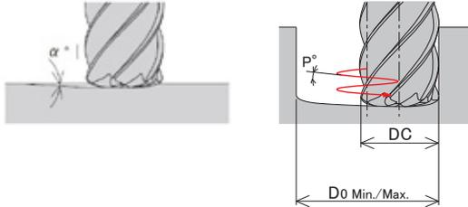
Параметры режущей кромки для корректного создания управляющей программы
