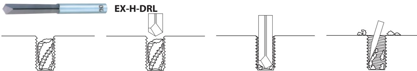
Поместите сверло в центр поврежденного метчика, обеспечив жёсткость детали и сверла. Если гребёнка поврежденного метчика выступает, отшлифуйте поврежденную поверхность для придания ей плоской формы, чтобы было легче высверлить центр поврежденного метчика.
