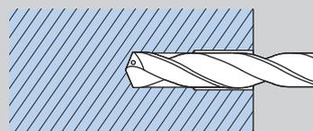
4 По завершению цикла сверления отведите сверло от дна отверстия, уменьшите обороты шпинделя до 500-1000 об/мин после чего сверло может быть окончательно выведено из отверстия.
